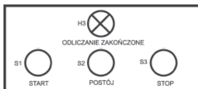
Rys. 2 Rozmieszczenie elementów na pulpicie sterowniczym
